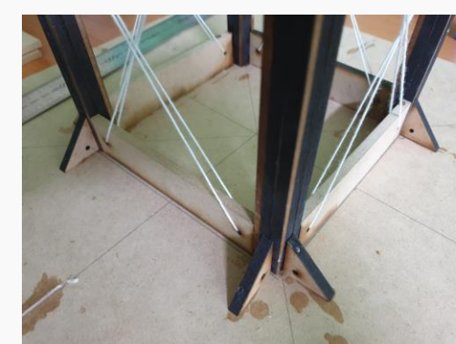
사각 보강 플레이트 설치
